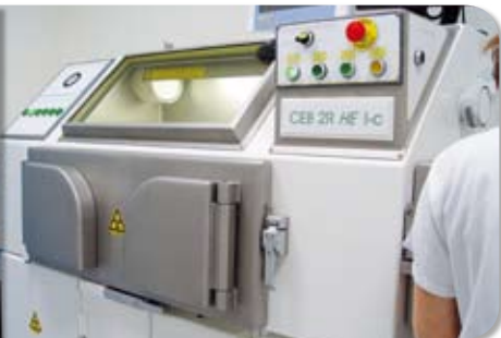
Isolateur blindé adapté aux rayonnements gamma de haute énergie
